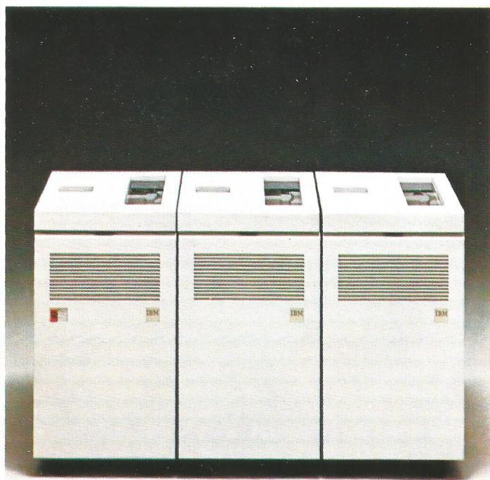
L'Unità a Nastri Magnetici IBM 8809 introduce un nuovo e semplificato design nel campo delle unità a nastro magnetico e, per le sue caratteristiche, è l'ideale complemento all'Elaboratore IBM 4331. L'IBM 8809, in linea con la nuova tecnologia, è un'unità compatta; trasporta il nastro magnetico direttamente da bobina a bobina senza l'ausilio di meccanismi di trascinamento e anse sottovuoto; regola la velocità e la tensione del nastro magnetico tramite un sistema di controllo elettronico.
